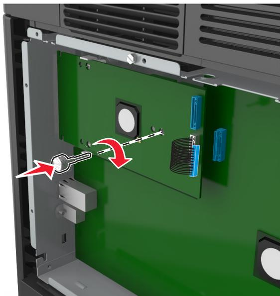
**Nota:** Ruotare la vite in senso orario in modo da tenere l'ISP in posizione, ma non serrare ancora la vite.
