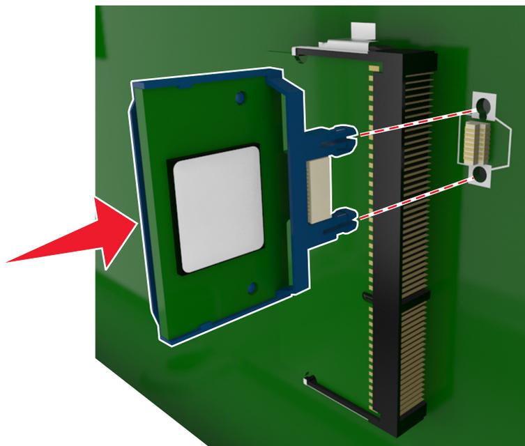
**Avvertenza — Danno potenziale:** L'installazione errata della scheda può danneggiare la scheda stessa e il controller.
