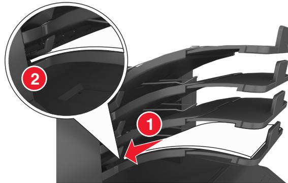
**Nota:** se la carta non si trova sotto il supporto, si verifica un inceppamento dovuto a un caricamento eccessivo del raccogliitore.
