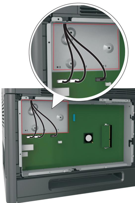
**Nota:** se attualmente è installato un ISP opzionale, è necessario installare il disco fisso della stampante sull'ISP.
