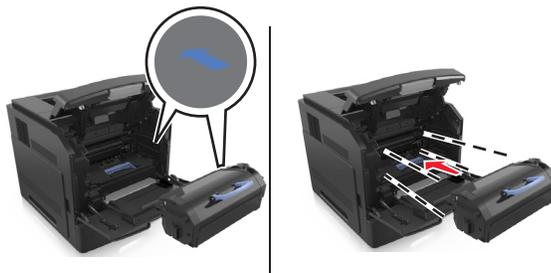
**Avvertenza — Danno potenziale:** Quando si sostituisce una cartuccia di toner evitare di esporre l'unità immagini alla luce diretta per un periodo di tempo prolungato. L'eccessiva esposizione alla luce può compromettere la qualità di stampa.
